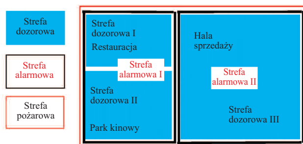
Rys. 1. Trzy strefy dozorowe z dwiema strefami alarmowymi
