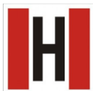
HYDRANT BEZ WĘŻA NA ZEWNĄTRZ BUDYNKU
